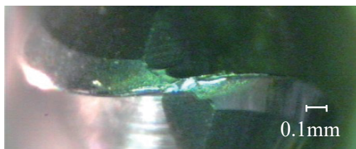
図8 チゼル部におけるチップングの発生(加工距離240m)
