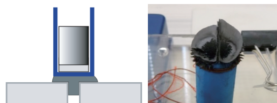
図11 スリット付きアクリルの隙間にMR流体が流入後に固化して吸着している様子
