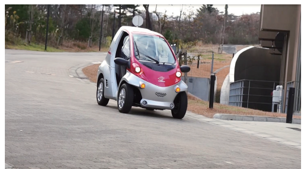
図10 四輪にドライMR流体ブレーキを搭載した超小型EVの走行試験の様子（坂道での一旦停止）
