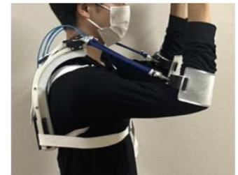
図 1 パワーアシストウェア 図 2 FLB の外観と応用
