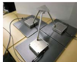
空圧で支持された平面運動形三脚パラレルメカニズム試作機
