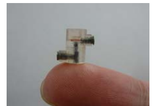
指先にのせた円筒形マイクロポンプの試作機
