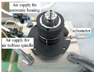
図1 エアタービンスピンドルの制御
