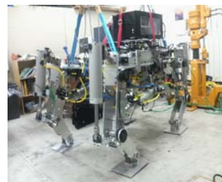
図3 空気式 4 脚移動ロボット
