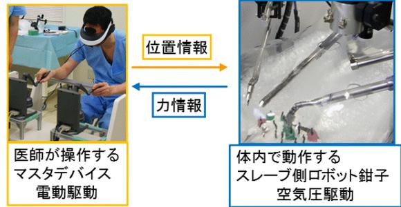
図1 空気圧駆動を用いた手術支援ロボットシステム
