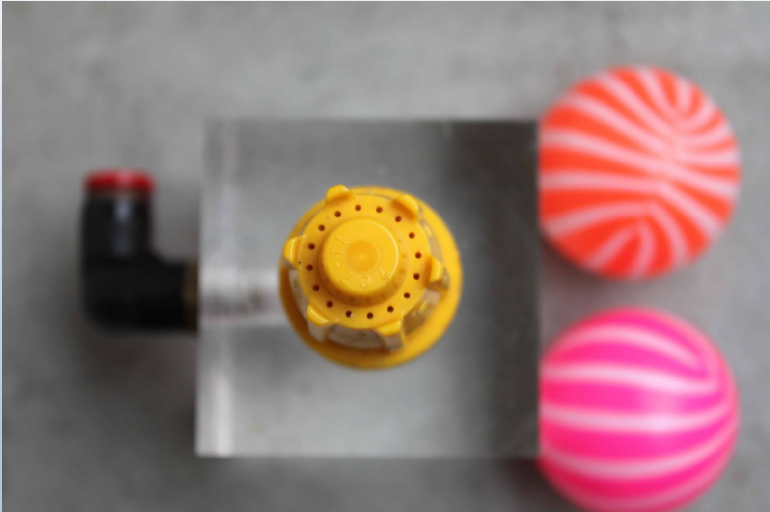
吹上げパイプのノズル部分
