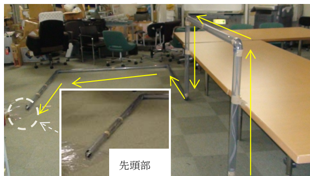
図7 全長14mの配管の推進実験
